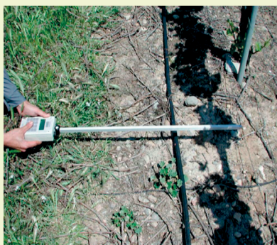
Figura 2. Ceptòmetre, aparell per fer mesures de la fracció de radiació interceptada de la vinya. Font: Programa Ús eficient de l'aigua de l'IRTA.
